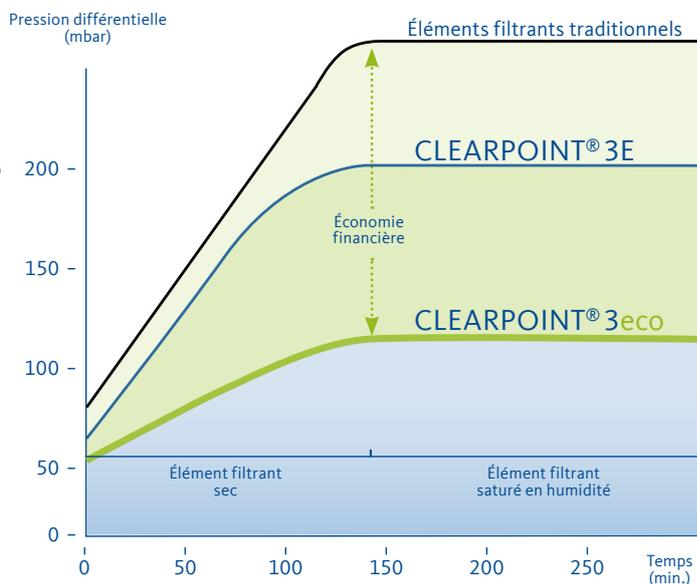
Les coûts d'exploitation des filtres CLEARPOINT® 3eco ont pu être nettement diminués. Le graphique les présente pour les filtres à brides avec le degré de filtration S pour un débit optimisé en efficacité énergétique.
