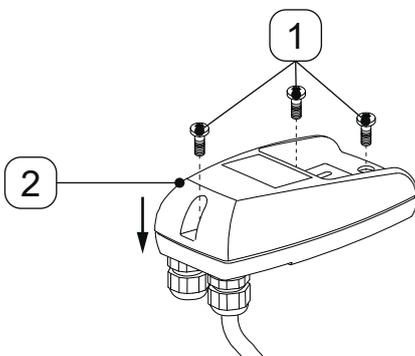
12. Das Haubenoberteil **[2]** aufsetzen und die Schrauben **[1]** einsetzen.
