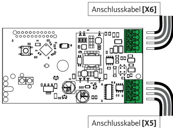
9. Das Anschlusskabel **[X5]** und das Anschlusskabel **[X6]** entsprechend Klemmenplan „4.7 Klemmenplan“ auf Seite 26 anschließen.
