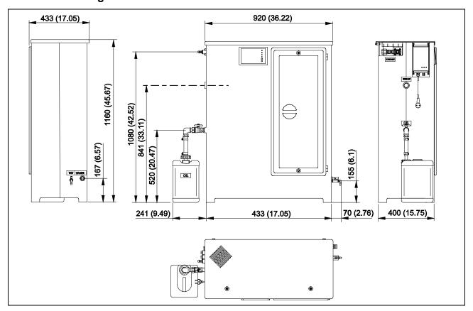
Maße sind keine zugesicherten Eigenschaften und unterliegen der Toleranz nach DIN ISO 2768-m
