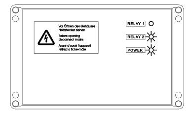
Liegt Betriebsspannung an und die BEKOSPLIT befindet sich in Bereitschaft im AUTO Modus (Startsensor unbedeckt), ist Relais KR2 angezogen. Der Kontakt (Klemme 23-24) ist geschlossen.
