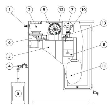
Das ölhaltige Kondensat kann der BEKOSPLIT unter Druck zugeführt werden (1). Der Überdruck wird in der Druckentlastungskammer (2) abgebaut, ohne dass es zu Verwirbelungen im Vorabscheidebehälter (3) kommt.
