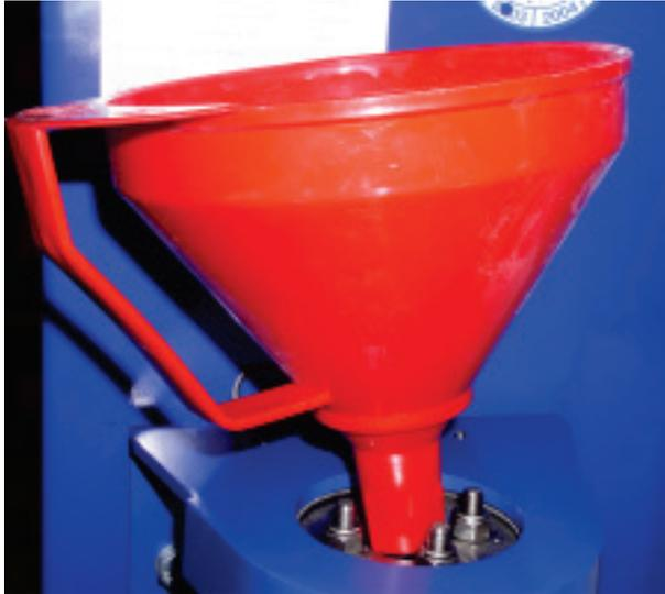
Befüllen Sie den Adsorptionsbehälter mit Adsorptionsmittel, Art und Menge gemäß Datenblatt.
