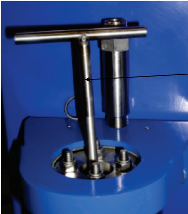
Führen Sie den Siebschlüssel (Spezialwerkzeug, nicht im Lieferumfang enthalten) in die Öffnung.
