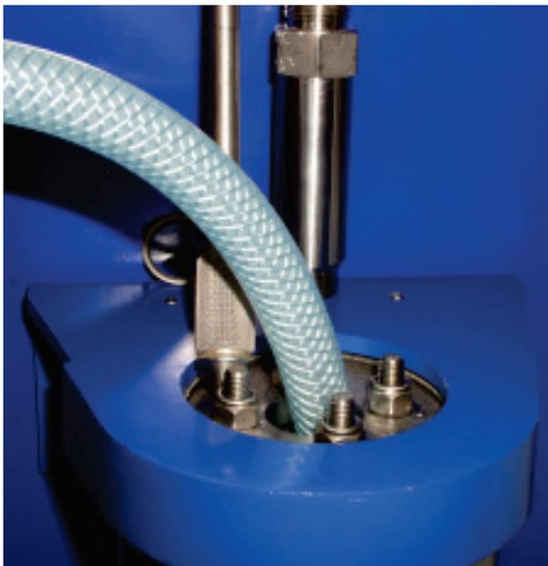
Führen Sie den Absaugschlauch einer industriellen Absaugvorrichtung in den Adsorptionsbehälter und entleeren Sie diesen vollständig.
