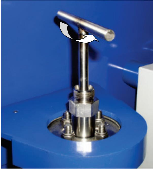
Kontern Sie mit Hilfe des Siebschlüssels den Siebeinsatz gegen den Stutzen.
