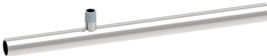
Bei kegeligem R-Gewinde erfolgt **die Abdichtung im Gewinde mit zusätzlichen Dichtwerkstoffen**. Verwenden Sie zur Abdichtung ein geeignetes, medienverträgliches Dichtmittel **wie z. B. PTFE-Band (EN 837-2)**.
