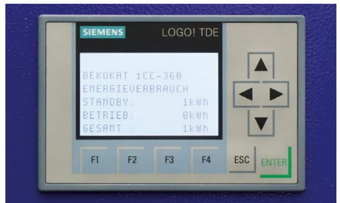
El menú de navegación del sistema de control SIEMENS permite una operación segura y fácil del BEKOKAT® y puede mostrar su estado, advertencias o instrucciones
