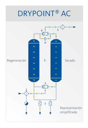
El secador de adsorción regenerado en frío DRYPOINT® AC garantiza un suministro continuo de aire comprimido de alta calidad.
