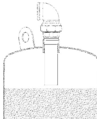
5. Monte el tapón de cierre con su junta en el tubo de llenado. En el caso del CLEARPOINT® L 205 VWM, vuelva a montar el distribuidor de aire comprimido y realice de nuevo la conexión a la red de tuberías.
