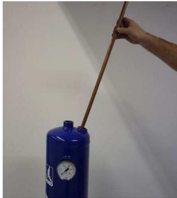
4. Rellene el depósito con carbón activo hasta justo por debajo del distribuidor de aire comprimido. Use exclusivamente el carbón activo original de BEKO TECHNOLOGIES GMBH. Ayúdese con un embudo.
