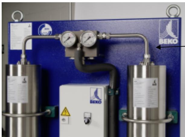
Desmonte la tubería que se encuentra por encima de los depósitos de adsorción.
