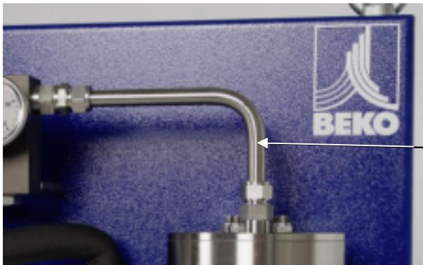
Vuelva a montar la tubería por encima de los depósitos de adsorción.
