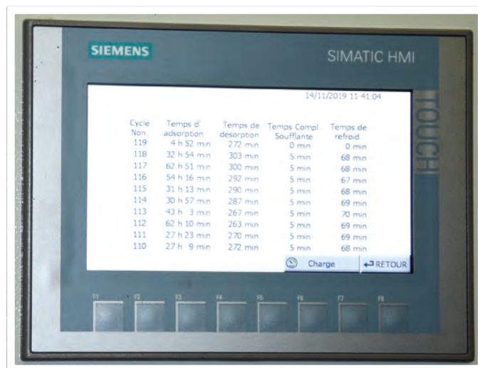
Sur le tableau de commande multifonction, le client a également la possibilité de visualiser les temps de cycles de régénération du sécheur EVERDRY modèle FRL 5000
