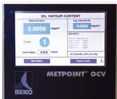
*L'analyseur de la présence d'huile résiduelle METPOINT OCV a permis au client d'attester la qualité et la pureté de son air comprimé process et surtout de confirmer qu'il dispose d'un air comprimé de classe 1 selon ISO 8573-1.*
