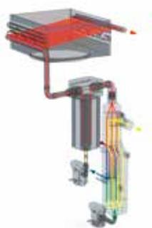
Le refroidisseur efficace intégré dans le sécheur frigorifique d'air comprimé DRYPOINT® RA HT permet des températures d'entrée de l'air comprimé pouvant atteindre 100 °C.
