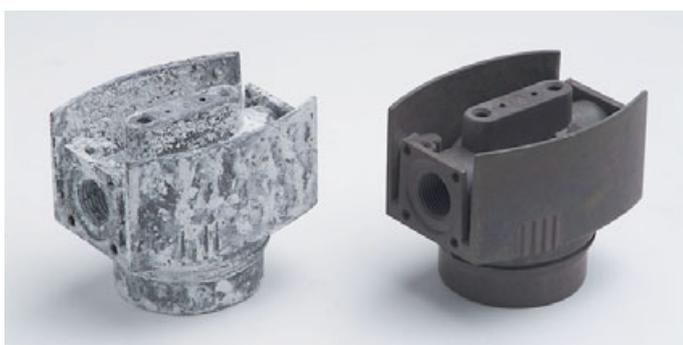
Le corps dont la conception favorise la circulation de l'air, est protégé de manière optimale contre la corrosion par un aluminium résistant aux milieux salins ainsi que par l'anodisation intégrale et le poudrage électrostatique supplémentaire. Par conséquent, les filtres Haute Pression CLEARPOINT® résistent également aux condensats agressifs.
