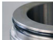
Joint torique de corps avec étanchéité radiale. Avantage : pas de détérioration du joint torique lors du remplacement de l'élément filtrant (risque existant en cas d'utilisation de joints toriques axiaux).
