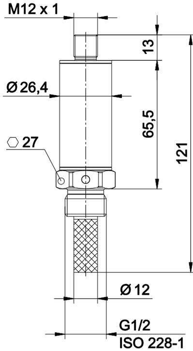
Dimensions DPM SD21 avec connecteur de raccordement (droit)
