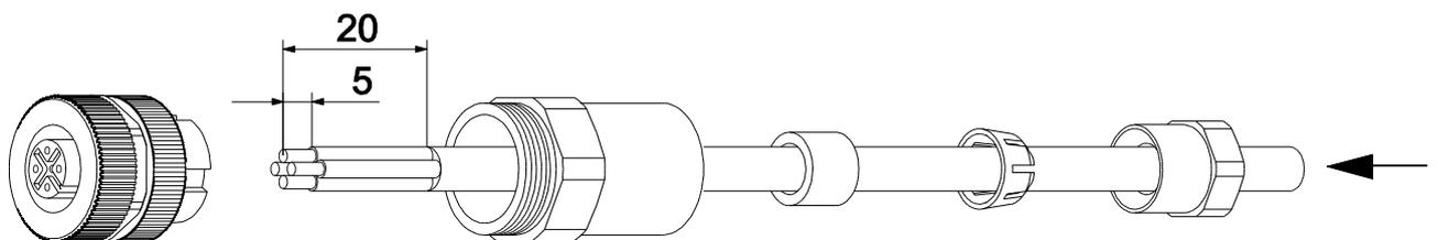
Il est recommandé d'utiliser du câble blindé pour réaliser l'installation. Le blindage s'effectue par l'intermédiaire de la bague de blindage de la liaison enfichable. Condition à remplir : le connecteur enfichable correspondant doit être en métal et le blindage doit être assuré par une tresse. Le blindage doit être mis à la terre d'un côté.
