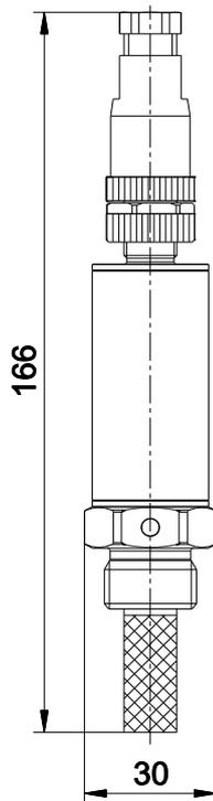
Dimensions DPM SD21 avec connecteur de raccordement (coudé)
