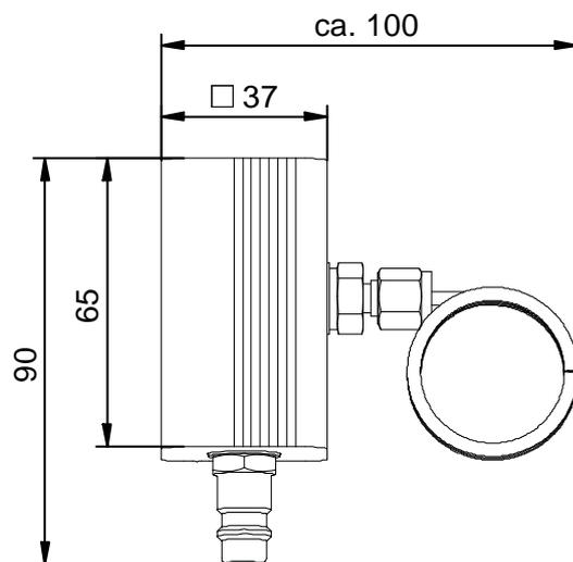
Dimensions Chambre de mesure Vario avec régulateur d'air de balayage
