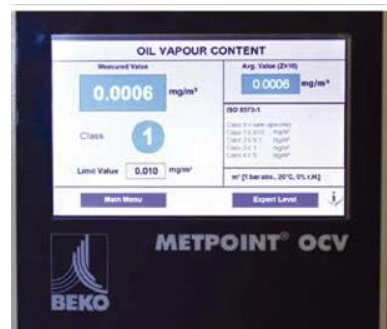
Il sistema di monitoraggio METPOINT OCV controlla e certifica la purezza dell'aria compressa.
