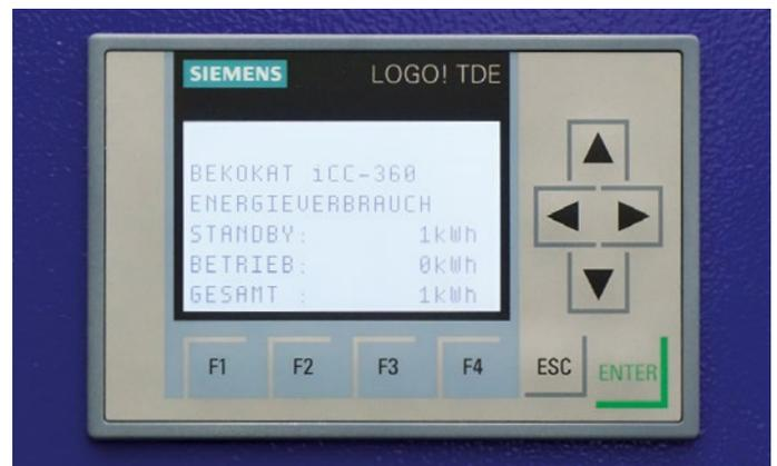
La navigazione a menu del sistema di controllo SIEMENS consente una gestione semplice e sicura dell'impianto e visualizza lo stato operativo, eventuali allarmi o istruzioni.
