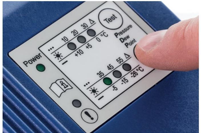
Con punti di rugiada in pressione fissi, DRYPOINT® M eco control rappresenta la via di mezzo fra un essiccatore a ciclo frigorifero e un essiccatore ad adsorbimento. E' possibile scegliere tra due modalità operative, a seconda delle esigenze della propria applicazione: "Constant Mode", quando occorre avere punti di rugiada in pressione fissi e stabili, e "Dynamic Mode", quando è necessaria una differenza costante rispetto alla temperatura dell'aria
