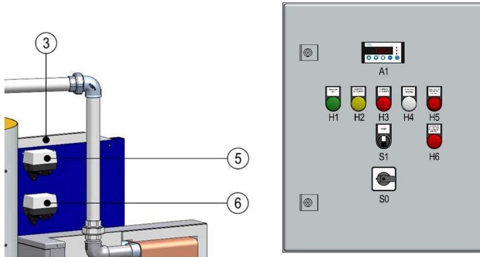
Il dispositivo di controllo temperatura TW (5) è installato nella parte superiore del reattore, sulla parete del contenitore, e si apre quando viene superato il valore limite, impostato a +260°C.
