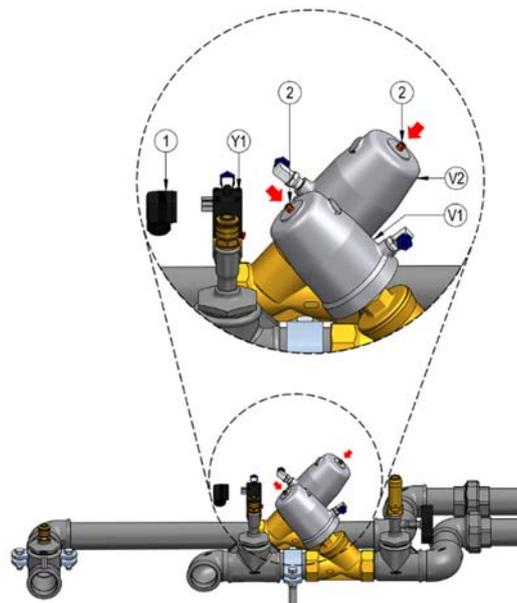
Quando si aprono le valvole con sede inclinata V1 e V2, gli indicatori di posizione delle valvole (2) si muovono verso l'alto uscendo dall'azionamento delle valvole.
