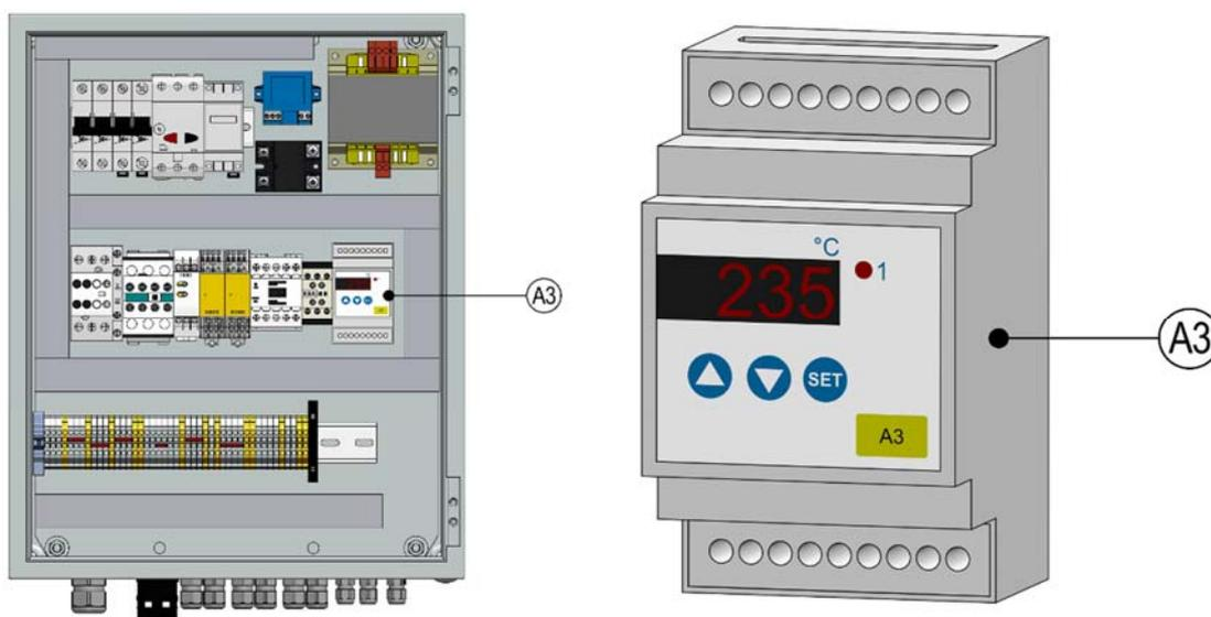
Sia il rilevatore della temperatura di sicurezza TW che il limitatore della temperatura di sicurezza STW sono collegati al regolatore della temperatura A3. Con questo regolatore si realizza l'accensione e lo spegnimento dei riscaldanti in base al valore delle temperature sulla parete del serbatoio.
