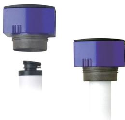
96%という極めて大容積の空隙をもった、ポロンシリケートのフィルター材料により、確実に圧力損失が最低限に保たれます。従来のフィルター材料である焼結ポリエチレンには、空隙率が45%しかありません。従って、**CLEARPOINT®**フィルターによる流量に有効な断面積は、2倍よりも大きくなります。
