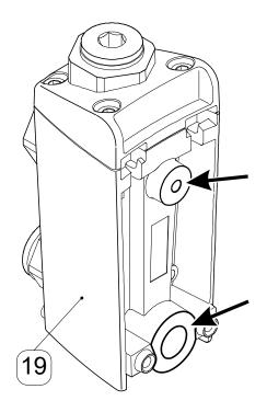
11.レシーバータンク(19)の接合面 (←) を洗浄します。
