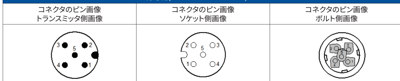
コネクタAのピンサイン、M12×1、5ピン、A符号化(EN 61076-2-101による)
