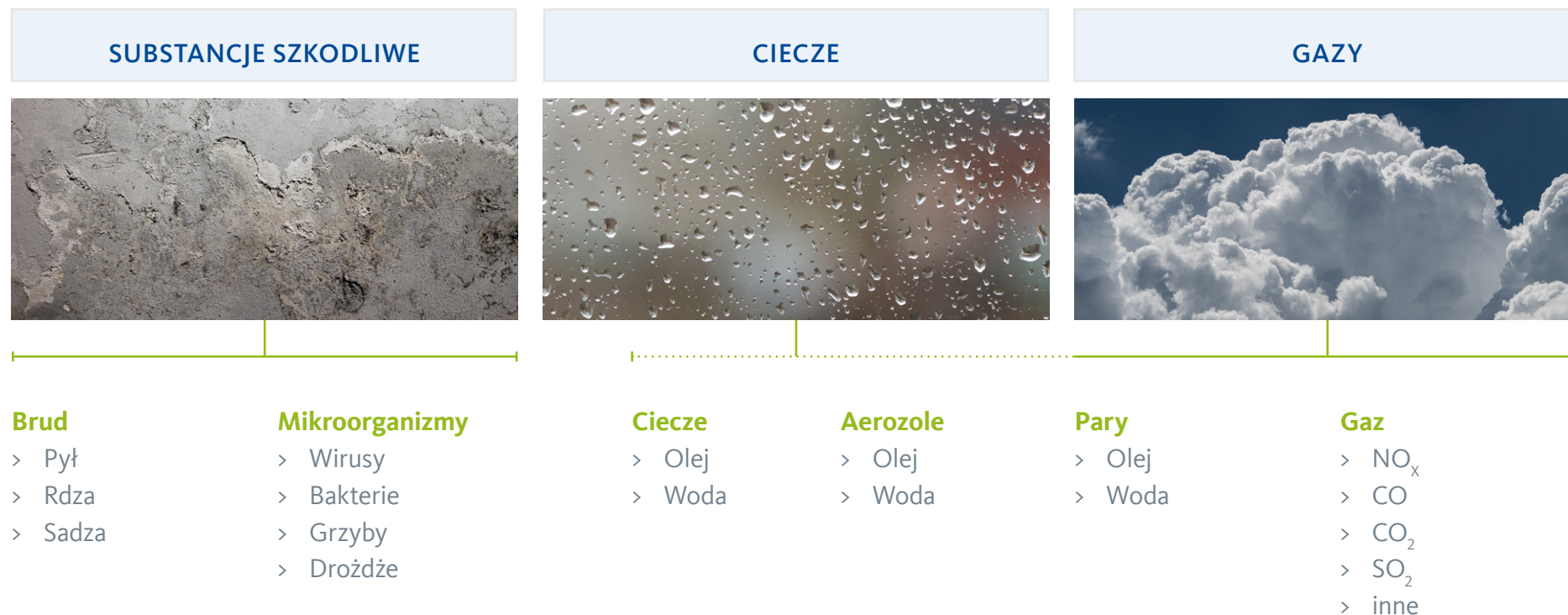
Rys. 2: Możliwe zanieczyszczenia w sprężonym powietrzu
