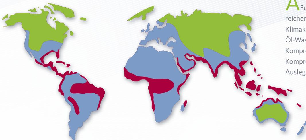
Aufgrund der einzigartigen aktiven Funktionsweise des **QWIK-PURE®** reichen die Kompressorleistung und die Klimakarte aus, um den bestmöglichen Öl-Wasser-Trenner auszuwählen. Die Kompressorenart und das verwendete Kompressoren-öl werden nicht mehr als Auslegungsfaktor herangezogen.
