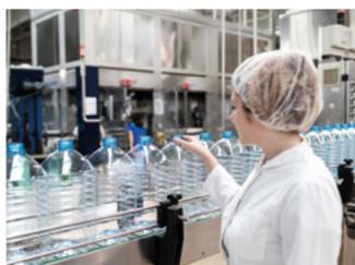
**In Verpackungsmaschinen:** Die Druckluft kommt in indirektem Kontakt mit dem Lebensmittel. Hier empfiehlt der VDMA eine Druckluftqualität von 2:4:2 \*
