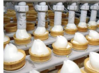
Bei **nicht-trockenen Lebensmitteln** mit direktem Kontakt empfiehlt der VDMA eine Druckluftqualität von 2:4:1 \*
